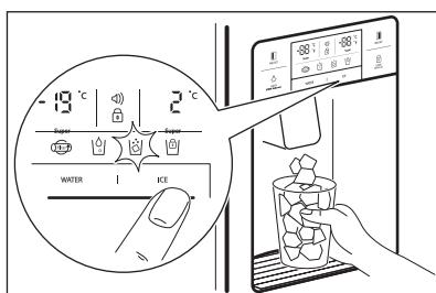
Kun jääkuutioiden lokeroa puhdistetaan tai sitä ei käytetä pitkään aikaan, poista jääkuutiot jääen säilytyslokerosta ja lukitse jäälakone painamalla painiketta ICE 3 sekunnin ajan. -merkkivalo sytyy.
