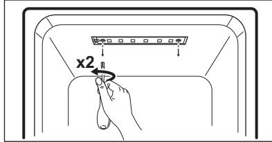
3. Kobl ledningssættet fra LED-pladen, og udskift LED'en.
