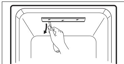
2. Irrota LED-valon suojuksen ja löysää LED-valon levyn 2 kiinnitysruuvia.
