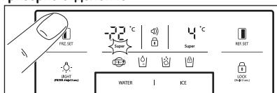
За настройка на температурата натиснете бутона **FRZ. SET**, докато се появи желаната стойност. За функцията "По-бързо замразяване", задържте бутона **FRZ. SET**, докато се включи силен светодиод. За да спрете тази функция, просто натиснете бутона отново.
