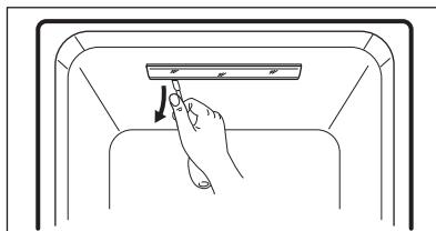
2. Tag LED-dækslet af, og løsn 2 monteringsskruer til en LED-plade.
