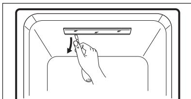
2. Odvojite poklopac LED svjetla i odvijte 2 pričvsna vijka ploče LED svjetla.
