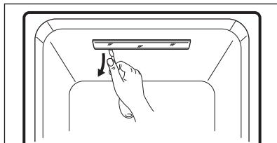
2. Отстранете капака на светодиодите и разхлабете 2 фиксиращи винта за светодиодната пластина.
