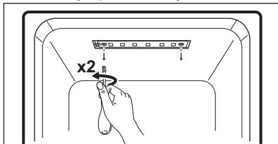
3. Odspojite ožičenje ploče LED svjetla i zamjenite LED svjetlo.
