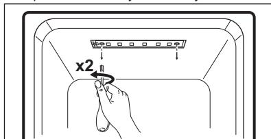
3. Odpojte kabelový svazek LED desky a vyměňte LED.
