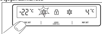
Za podešavanje temperature pritišćite tipku **FRZ. SET**, dok se ne prikaže željena temperatura.
