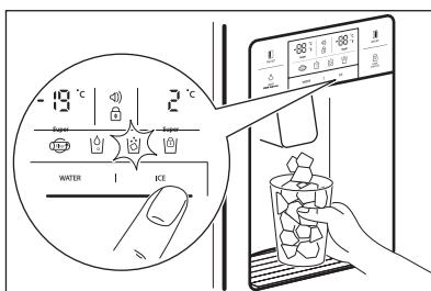
Wanneer u het ijsblokjesssysteem reinigt of wanneer u het voor lange tijd niet gebruikt, verwijder de ijsblokjes uit de bewaarbak en vergrendel de ijsmaker door gedurende 3 seconden op de toets ICE te drukken. De zal oplichten.
