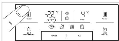
Teplotu nastavíte tisknutím tlačítka **FRZ. SET**, dokud se nezobrazí požadovaná hodnota.
