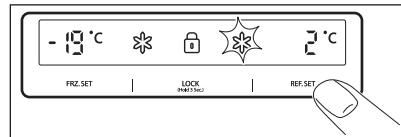
Za podešavanje temperature pritišćite tipku **REF. SET**, dok se ne prikaže željena temperatura.
