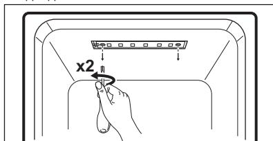
3. Разкачете ремъците на светодиодната пластина и подменете светодиода.
